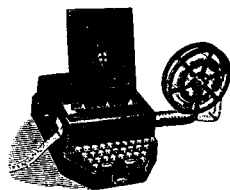
Фиг. 14. Перфоратор Сименса.
