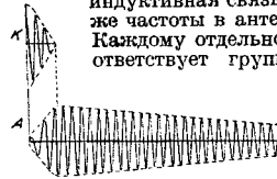
Фиг. 2. Свободные колебания в связанных колебательных контурах.
