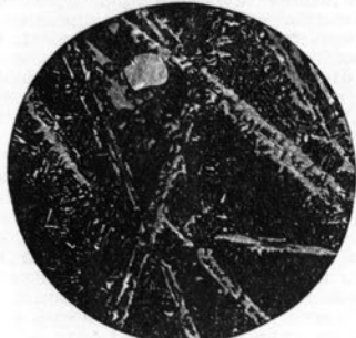
Фиг. 4. Микроструктура базальта, расплавленного и остеклованного при быстром охлаждении. Увел. 75.
