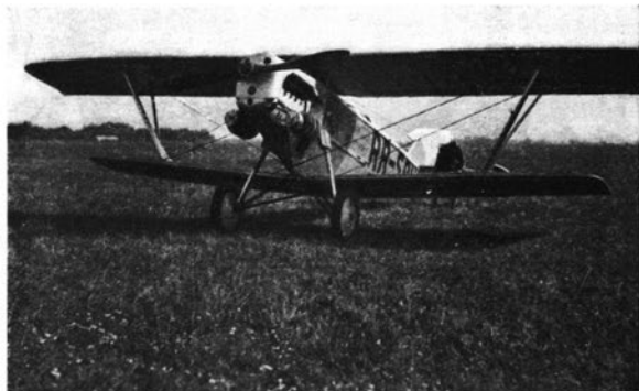
А.—АНТ-3 конструкции А. Н. Туполева с мотором Непир „Lion“ 450 HP на к-ром совершен перелет в. л. Шестаковым из Москвы в Токио и обратно.
