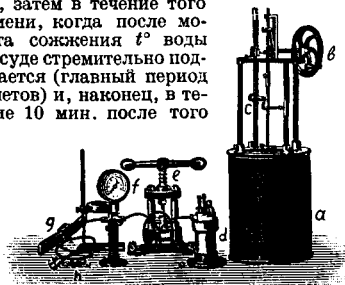
Фиг. 2. f —манометр для кислорода, e —пресс для таблетирования навески.
