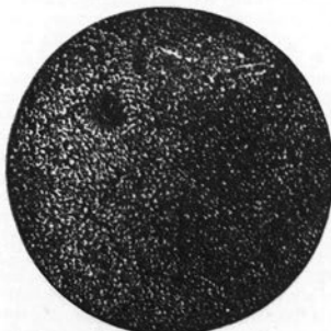
Фиг. 5. Микроструктура базальта регенерированного. Увел. 30.
